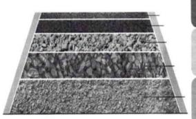
Revestimento asfáltico – formado por mistura de agregados e cimento asfáltico. Recebe as cargas do tráfego e distribui para as camadas estruturantes
